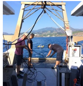
Acquisition de sismique réflexion en mer
