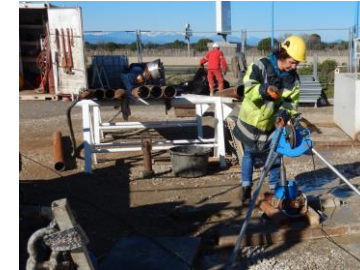
Acquisition géophysique de diagraphies dans les forages Dem'Eaux
